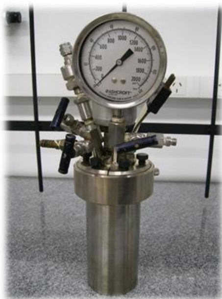
Figura 29: Reator em aço inox, modelo PARR, utilizado nas reações de oligomerização.
