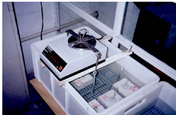
FIGURA 25 - O aparato do ensaio de absorção.
