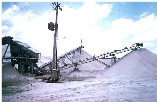
FIGURA 27 - Peneiramento, lavagem e classificação do seixo.
