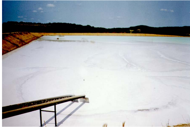
FIGURA 17 - Bombeamento da polpa de caulim para as lagoas.
