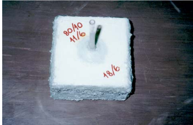
FIGURA 24 - Corpo-de-prova prismático preparado para o ensaio de absorção.
