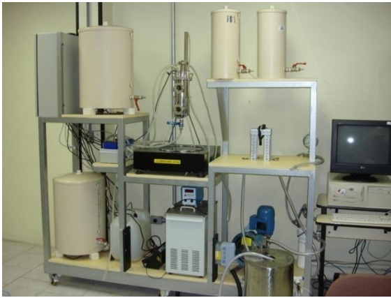
Figura 1. Planta laboratorial para fermentações em modo batelada ou contínuo de Zymomonas mobilis .
