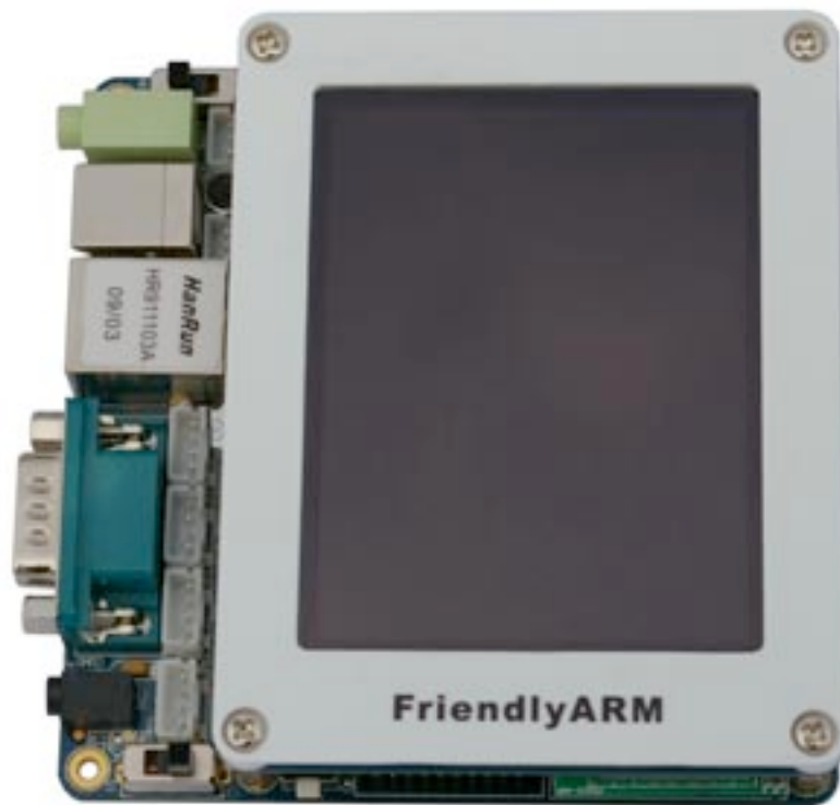
Figura 3 – Placa de desenvolvimento em processadores ARM
