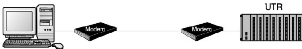
Figura 5.3 - Conexão PC-UTR utilizando modems .
