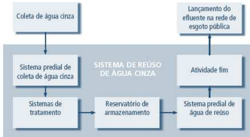
Figura 5: esquema do sistema de reúso (BRASIL et al., 2005, p. 74)
