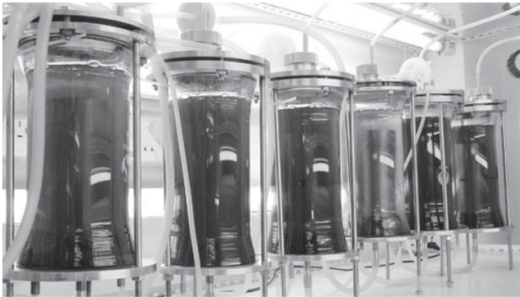
**Figura 2.4.** foto de biorreatores do tipo *airlift*, com uma cultura de microalgas crescendo em seu interior (Fonte: Xu et al., 2009).
