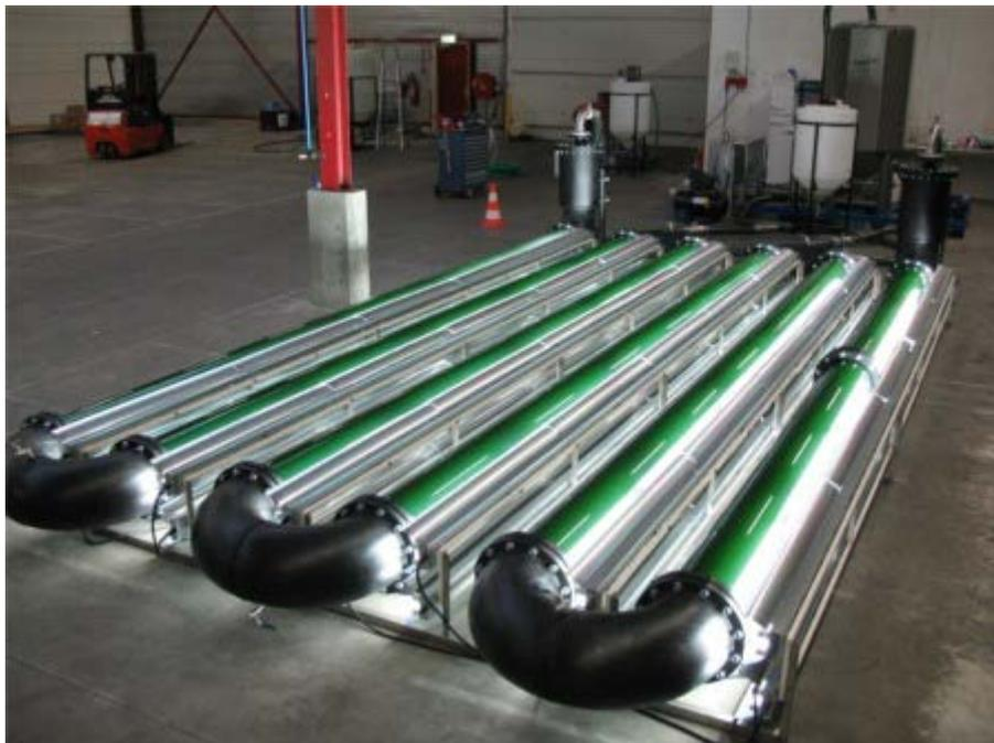
**Figura 2.1.** Um fotobiorreator tubular (imagem extraída do site: <http://mybelojardim.com/combustiveis-aquicolas-sistemas-algas-de-tanques-abertos-fotobioreatores/> em 14 de dezembro de 2010).
