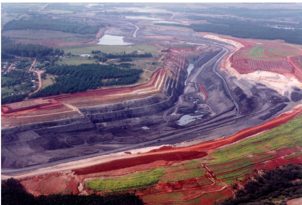
Figura 1.2: Método de lavra strip mining . Vista aérea do corte Coréia da Mina do Recreio. Fonte: Copelmi Mineração Ltda.
