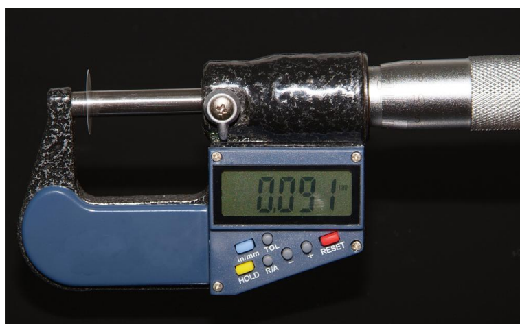
Figura 3. Micrômetro realizando medição de corpo de prova.
