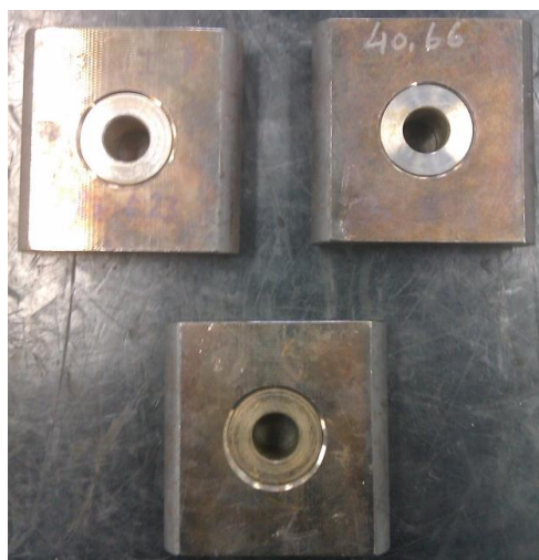
Figura 4.3 – Componentes unidos por interferência
