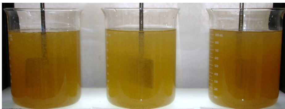
Figura 10: Teste de Jarro para os coagulantes comercial e obtido a partir da DAM
