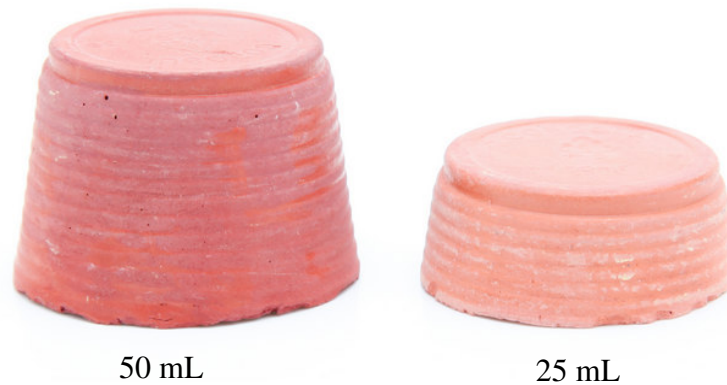
Figura 40: Imagem dos blocos de concreto cromático produzidos com os pigmentos Hematita Comercial e Hematita DAM.
