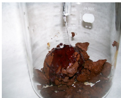
Figura 8: Dissolução do lodo por ácido sulfúrico.
