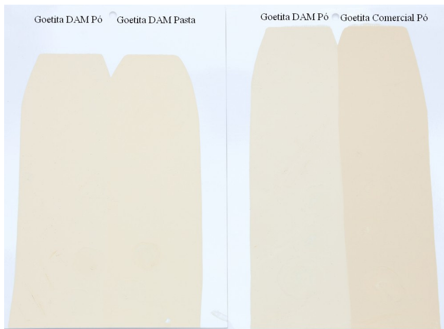
Figura 35: Lâminas confeccionadas para o Teste “Rub Out” com as tintas obtidas a partir da Goetita comercial e Goetita DAM produzidas em pó e em pasta.
