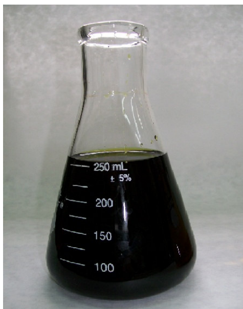
Figura 9: Coagulante produzido a partir do lodo obtido da precipitação seletiva.
