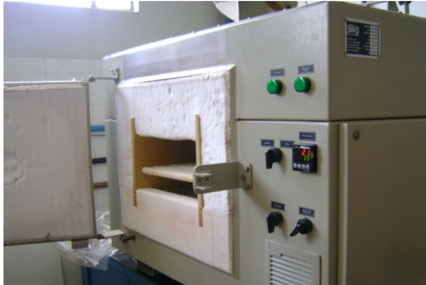
Figura 4.9: Forno Jung mufla Modelo 2713 – 1300 °C – 6,5 kw – 30 A, sem controle da atmosfera do IMG, usado nos experimentos preliminar .
