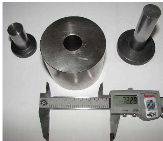
Figura 2.17: Matriz de compactação e punções fabricados para obtenção dos corpos de prova de 13mm diâmetro (ESPINOZA et al. , 2010).
