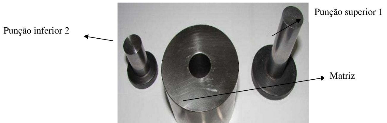
Figura 4.6: Conjunto matriz fechada para obtenção de corpo de prova de 13mm de diâmetro, nos experimentos preliminares, LDTM/UFRGS.
