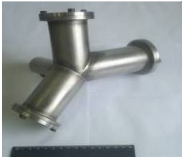
Figura 4.11: Detalhe do misturador tipo “Y” utilizado.
