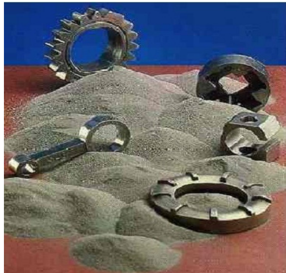
Figura 2.2: Peças produzidas através da metalurgia do pó (MORO; AURAS, 2007)
