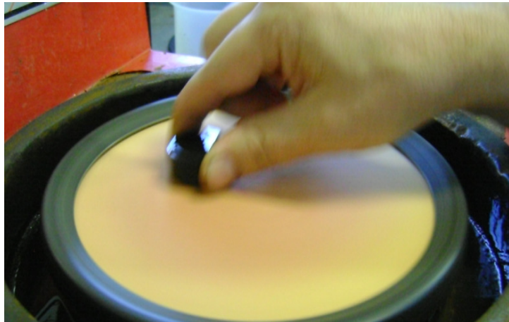
Figura 3.22: Exemplo de polimento com pano e pasta diamantada (abrasivo). Laboratório de Metalografia – SATC.
