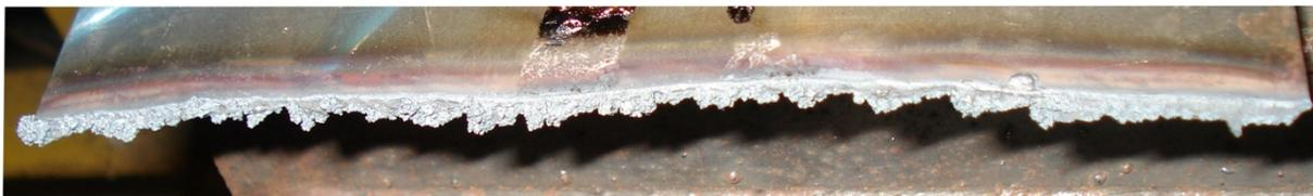
**Figura 4.46.** Vista lateral do corte de uma chapa de aço realizado com a tocha de plasma híbrida.
