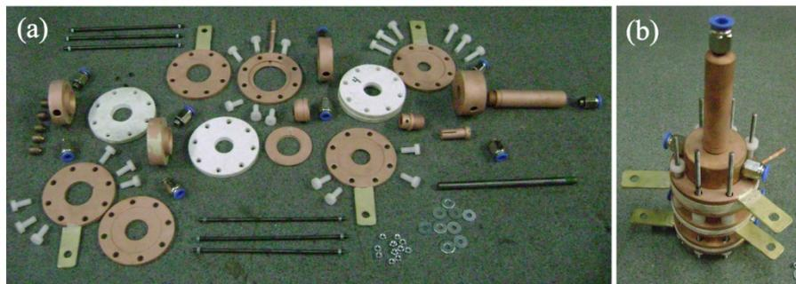
**Figura 3.3.** (a) Peças constituintes da tocha de plasma híbrida e (b) a mesma montada.
