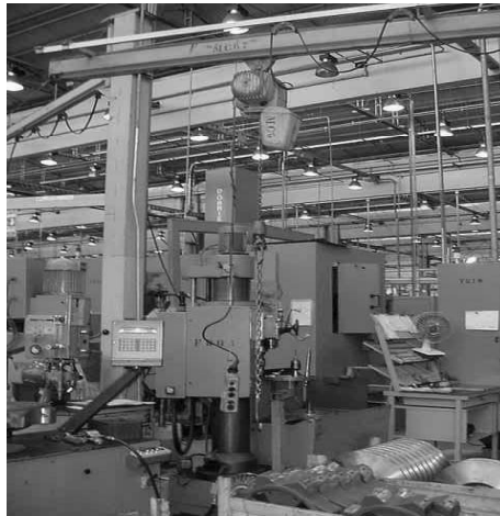
Figura 19: Talha de movimentação de peças.
