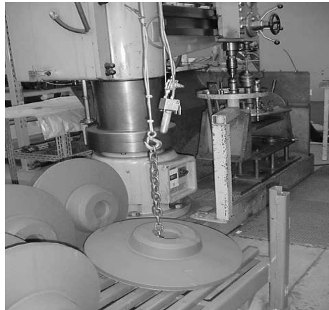
Figura 20: Detalhe do dispositivo para movimentação de peças.
