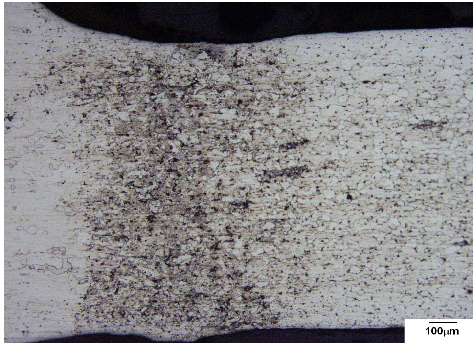
Figura 7.9 – Micrografia óptica do material ST 05 atacado com Nital 4% com aumento de 100X.
