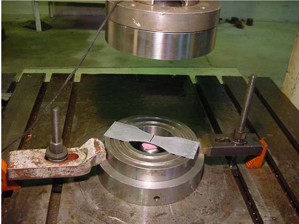
Figura 7.16 – Centragem do corpo de prova antes do ensaio.
