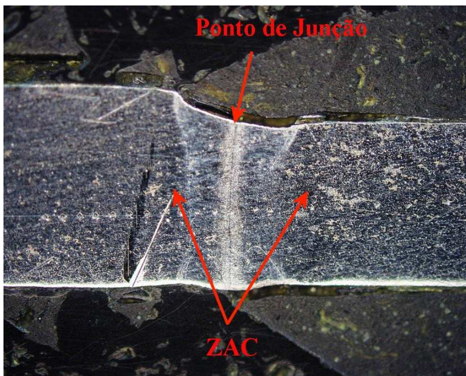
Figura 7.7 – Macrografia indicando a geometria do cordão de solda para o aço ST 05. Aumento 50X.
