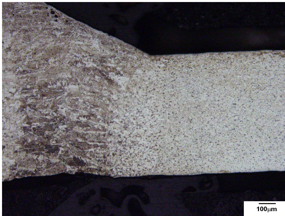
Figura 7.10 – Micrografia óptica do material ZStE 220P atacado com Nital 4% com aumento de 100X.
