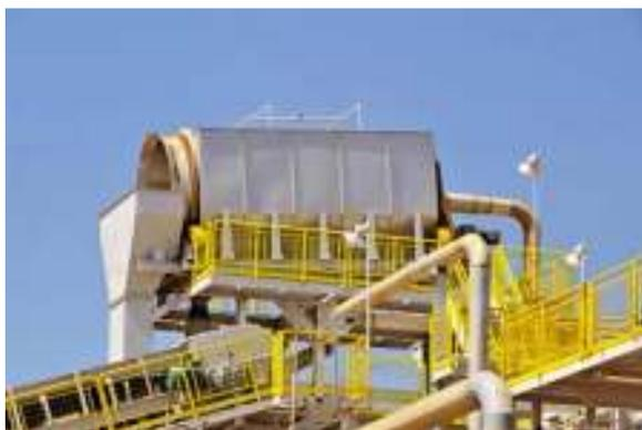
Figura 57 Peneira para separação da cana de açúcar
