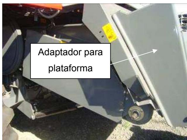
Figura 36 Adaptador para plataforma
