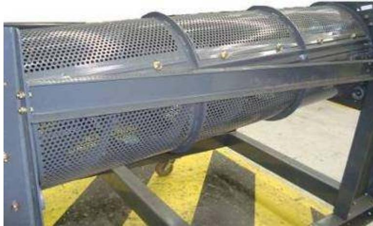
Figura 115 Rotor da peneira sem as coberturas
