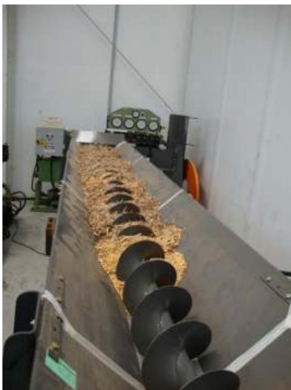
Figura 117 Helicóide adicional, mais ao fundo e helicóide transportador
