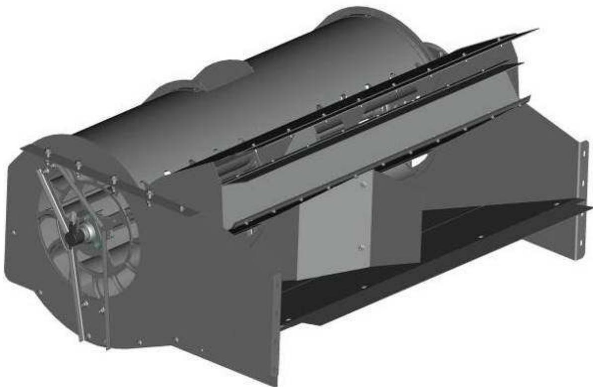
Figura 46 Sistema com descarga dupla
