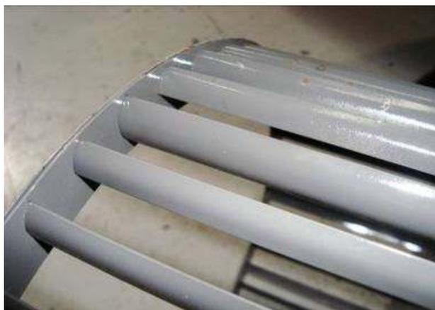
Figura 113 Rotor do ventilador
