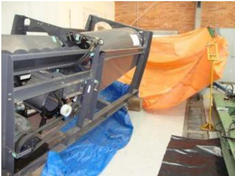
Figura 118 Bancada inclinada em 15°
