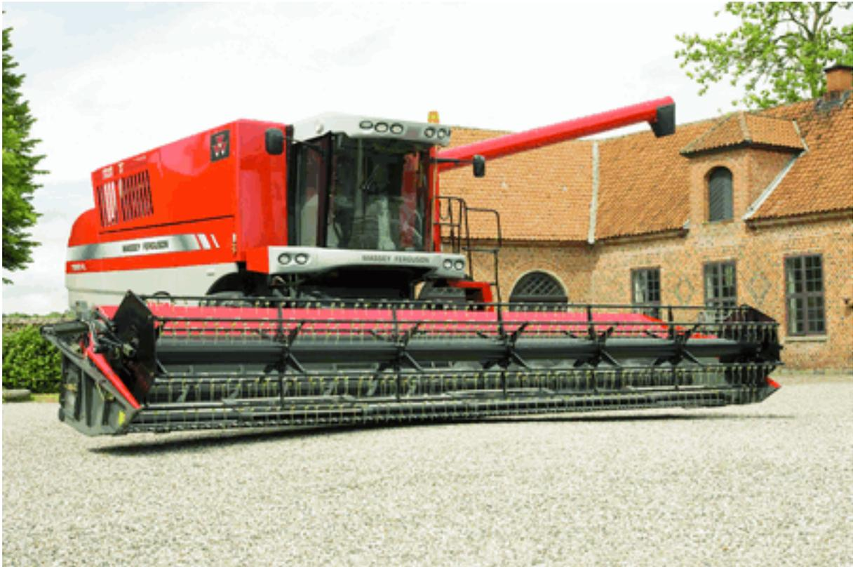
Figura 17 Plataforma Rígida
