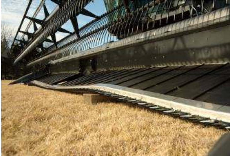
Figura 20 Plataforma *Draper* não possui helicóide transportador
