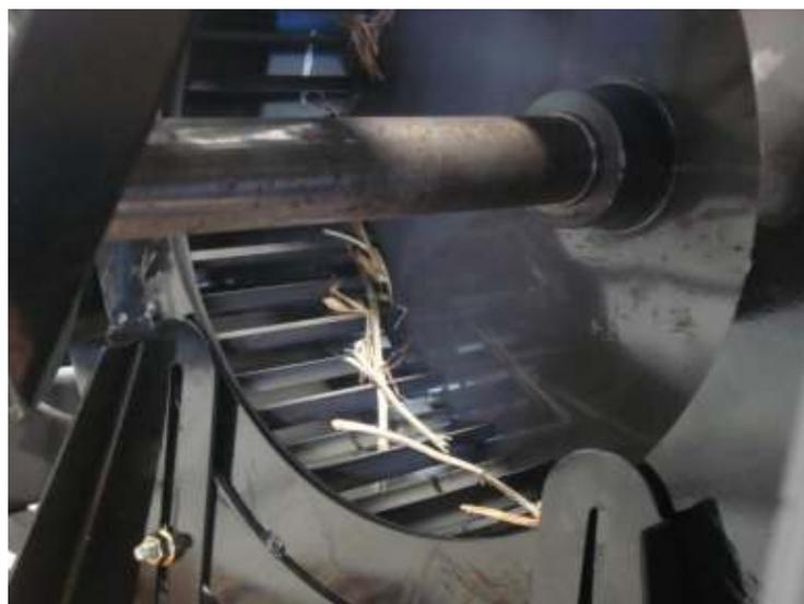
Figura 124 Contaminação do ventilador
