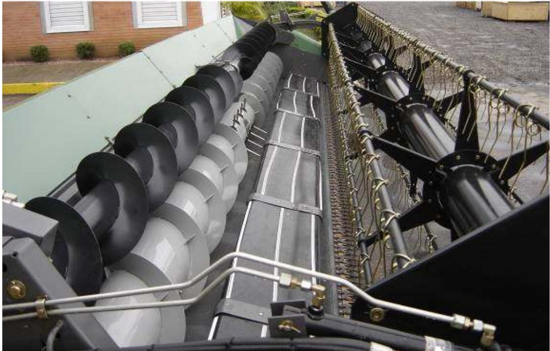
Figura 22 Plataforma combinada Powerflow
