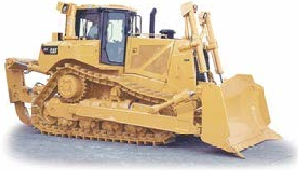
Figura 24. Dozer D8R com escarificador.
