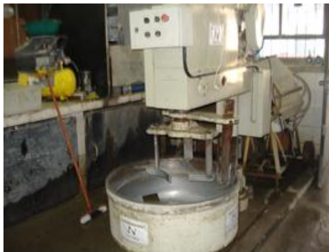
Figura 13 – Betoneira de eixo vertical utilizada para a confecção do concreto utilizado no experimento
