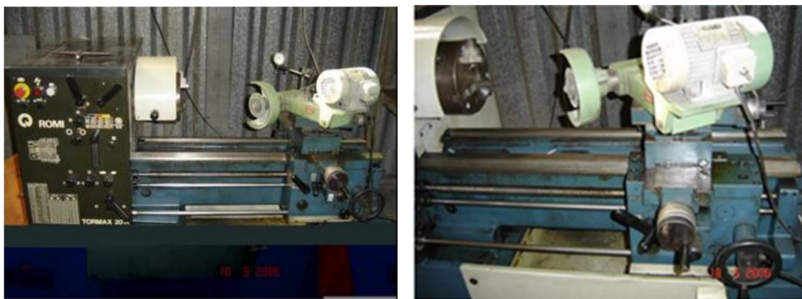
Figura 10 – Modelo de retificadora em que ocorre a rotação do CP enquanto sua superfície é desbastada por uma serra circular
