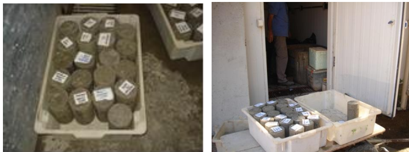
Figura 15 – Corpos-de-prova desformados e levados para ficarem imersos em solução saturada de hidróxido de cálcio
