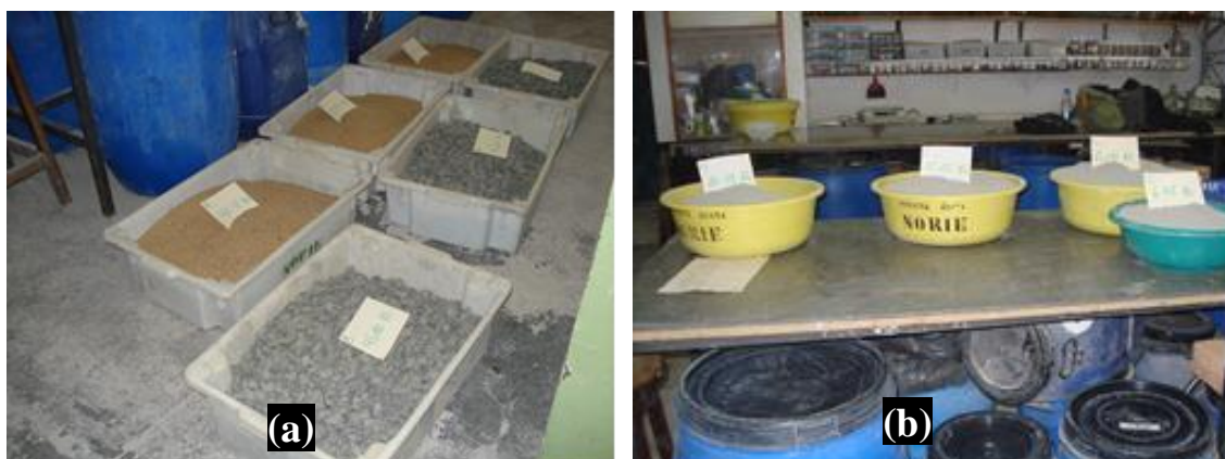
Figura 12 – Vista geral dos materiais (areia, brita e cimento) separados e pesados para confecção dos três traços de concreto: (a) detalhe dos agregados, (b) detalhe do cimento
