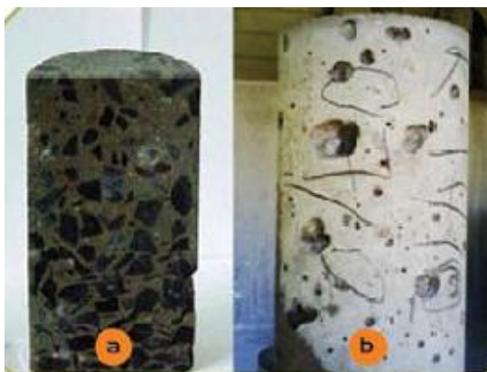
Figura 5 — Falha na moldagem vinculada ao adensamento incorreto: (a) corpo-de-prova seccionado ao meio (b) corpo-de-prova antes de ser rompido
