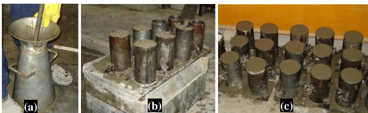
Figura 14 – Realização do ensaio de abatimento de cone (a), vibração (b), regularização dos topos e após corpos-de-prova moldados (c)
