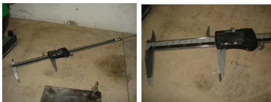
Figura 16 – Paquímetro digital utilizado para medir as alturas e diâmetros médios dos CP
