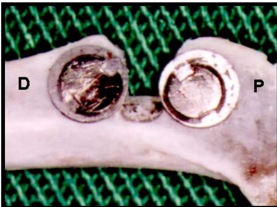
FIGURA 2 Protótipo inicial montado para a medição da intensidade do campo magnético. Observa-se a eliminação de duas corticais. O modelo foi modificado para possibilitar a aplicação do sensor. Observam-se as porções distal (D) e proximal (P) do fêmur.
