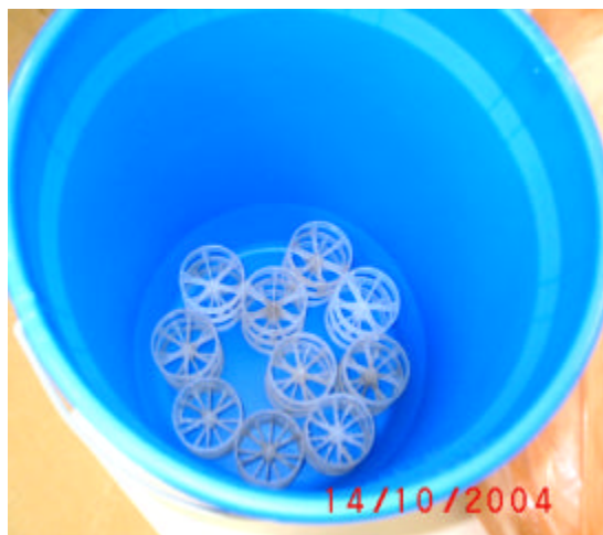
Figura 4.9: Cilindros plásticos vazados, (camada de sustentação)
