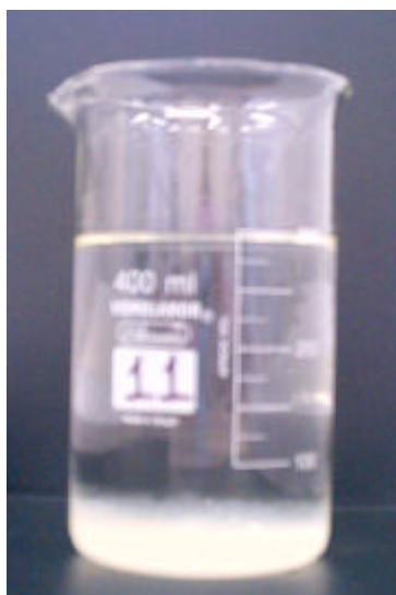
Figura 5.7: Aspecto do precipitado formado após a neutralização do percolado.
