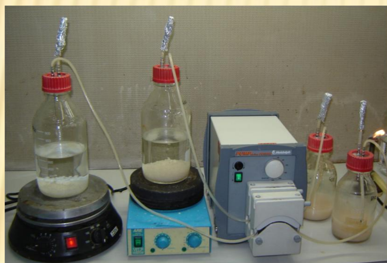
Fig. 1: Gotejamento do alginato de sódio 4%, sem suspensão celular, em solução estéril de cloreto de cálcio 0,1M.
