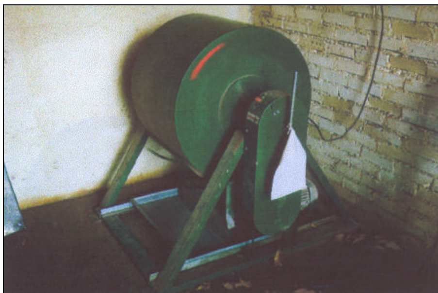
FIGURA 3.12 – Ensaio de desgaste Cantabro no equipamento Los Angeles
