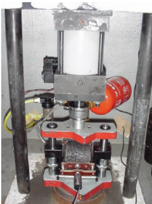
FIGURA 3.9 – Equipamento de fadiga fora da câmara termo-regulável
