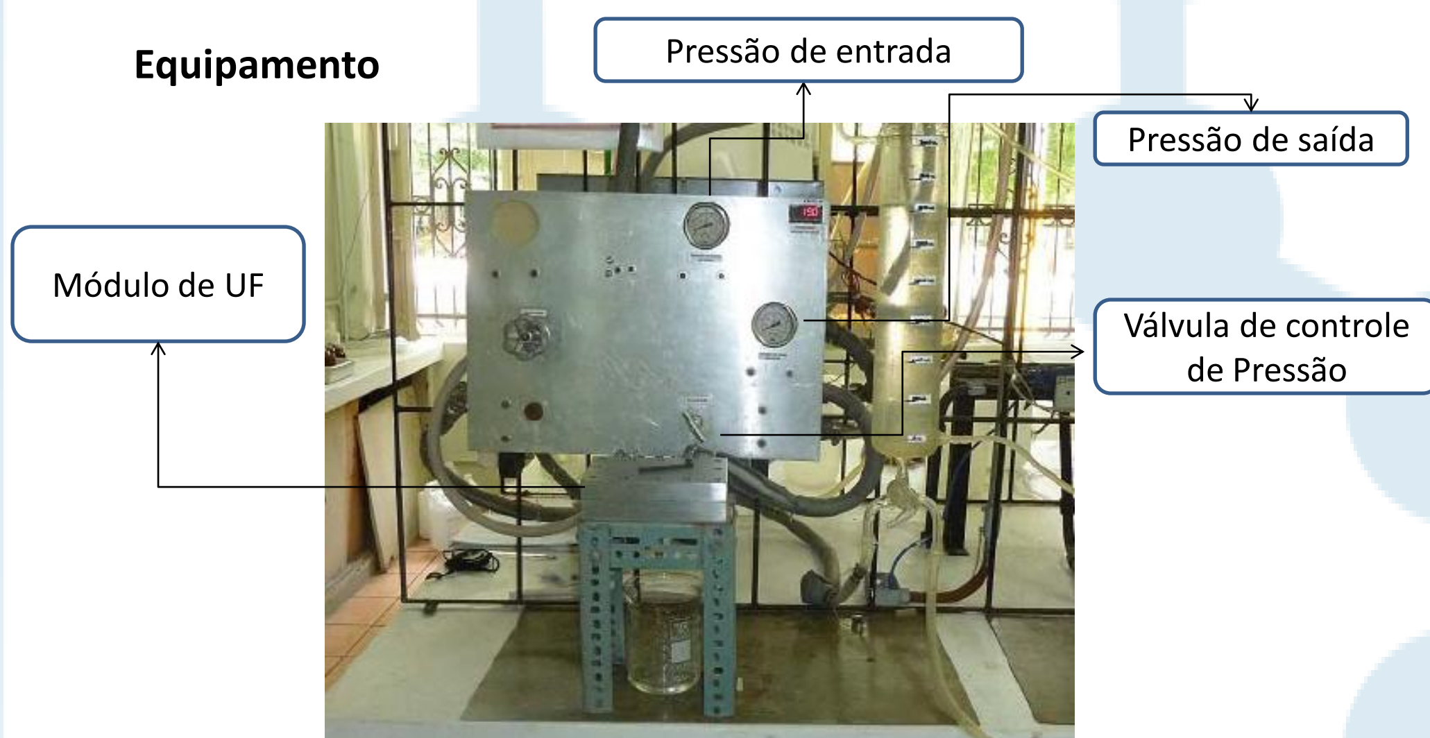
Figura 1: Sistema de bancada de ultrafiltração.
