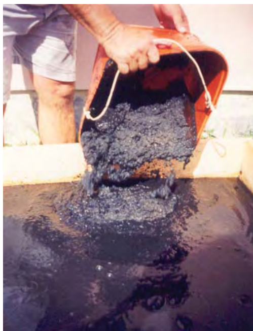
Figura 6 - Amostra do lodo de esgoto retirado da bacia de decantação (ETE de Osório, RS) para desaguamento em leitos de secagem.
