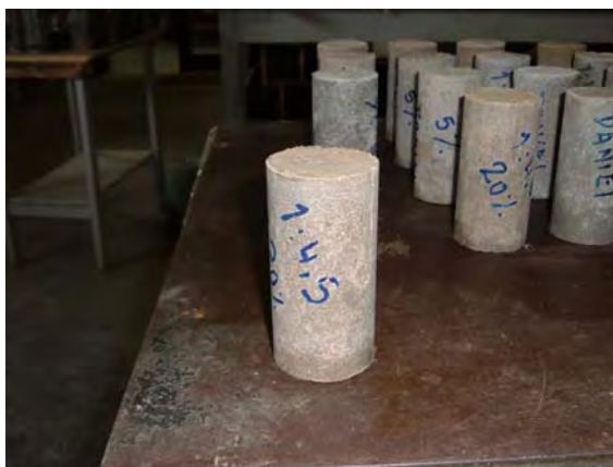
Figura 36 - Identificação do traço no corpo-de-prova
