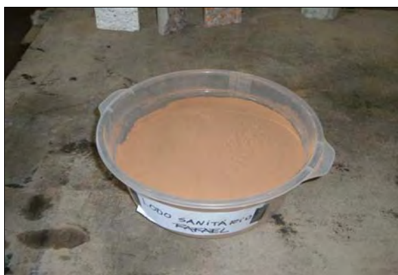
Figura 31 - Amostra da material após a calcinação e peneiramento
