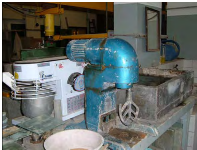
Figura 35 - Argamasseira utilizada na produção das argamassas
