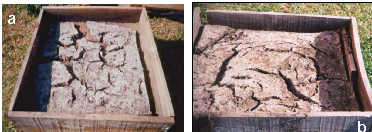
Figura 19 - Amostra de lodo parcialmente seco no protótipo de leito de secagem. (a) vista geral e (b) detalhe
