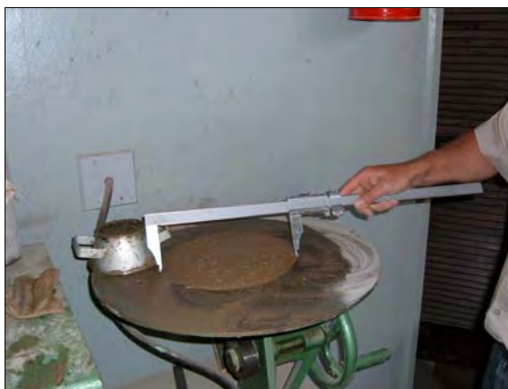
Figura 33 - Realização dos ensaios de consistência
