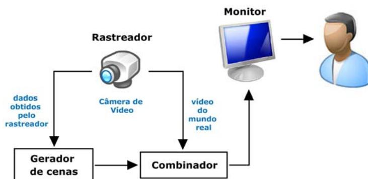
Figura 9 - Sistema de RA baseado em monitor.
