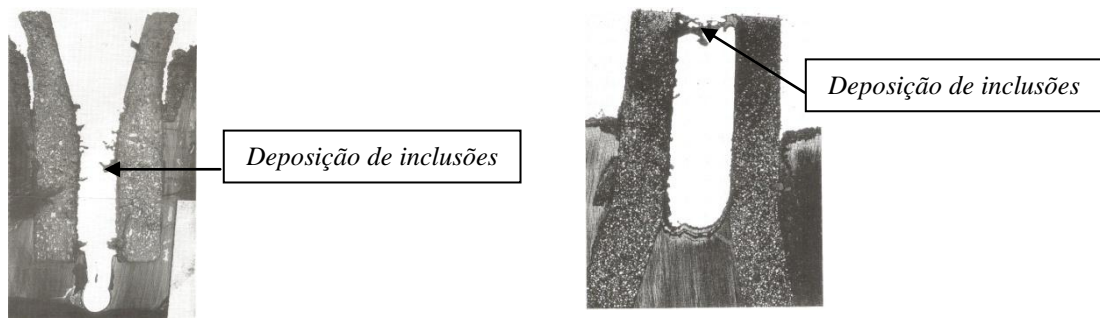
Figura 8 – (a) Corte transversal do canal de saída do aço (b) Corte transversal do canal de saída do aço na posição invertida (Adaptado da fonte: WILSON F. G. et al 1987).
