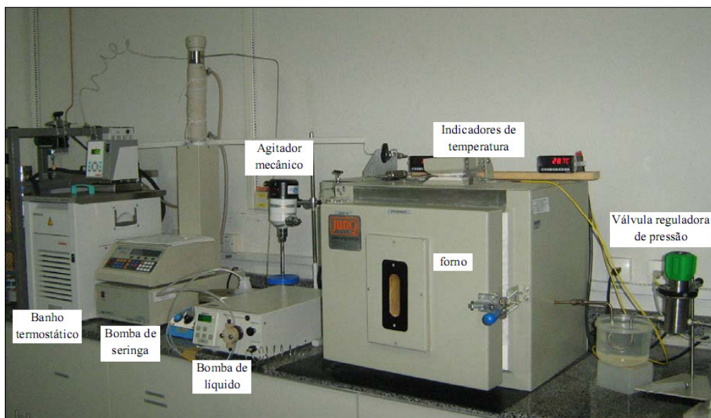
Figura 8: Vista geral da unidade de produção de biodiesel a alta temperatura e pressão, em modo contínuo.
