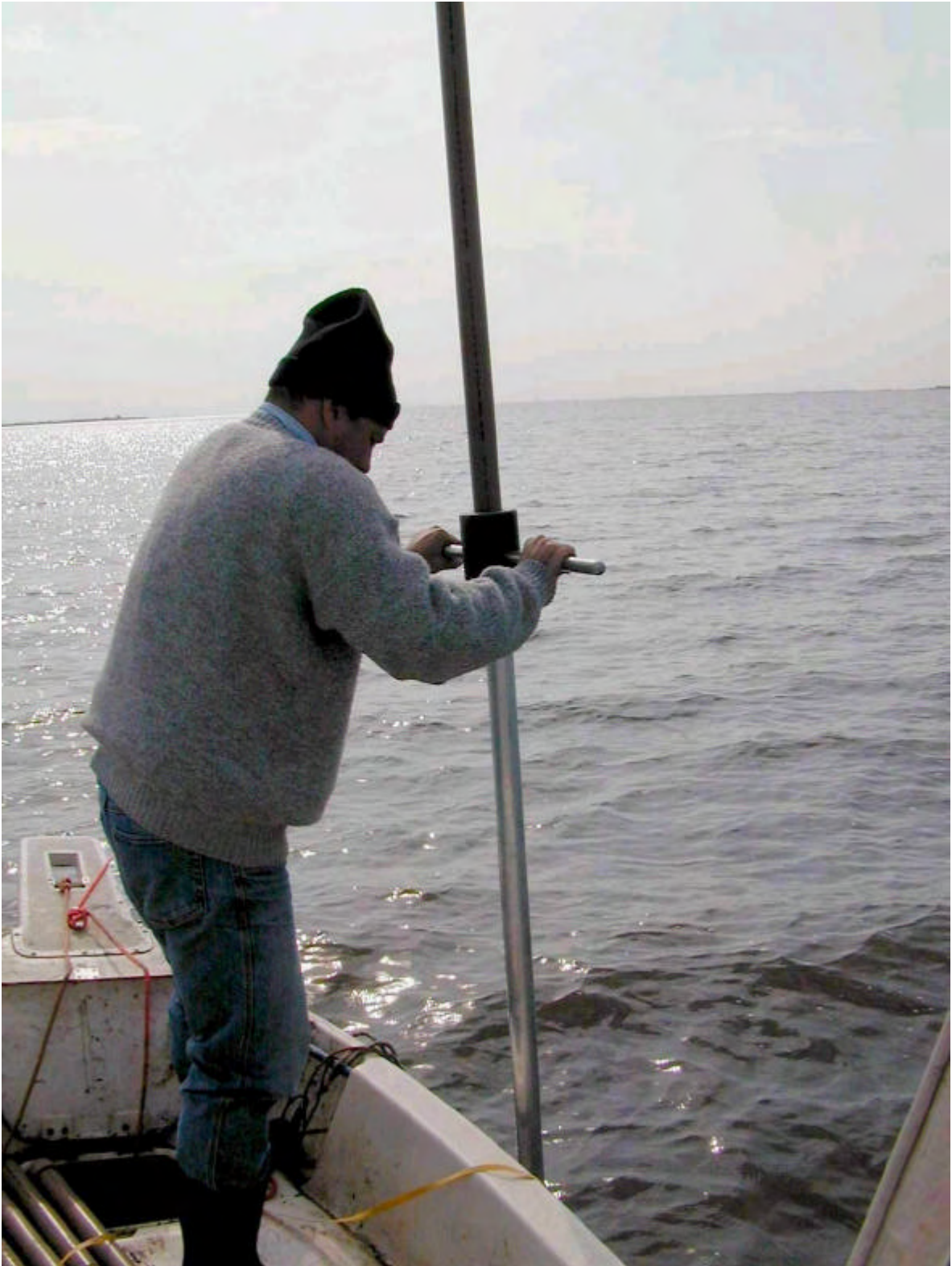
FIGURA 9: RETIRADA DE TESTEMUNHO NA LAGOA DO ARAÇÁ
