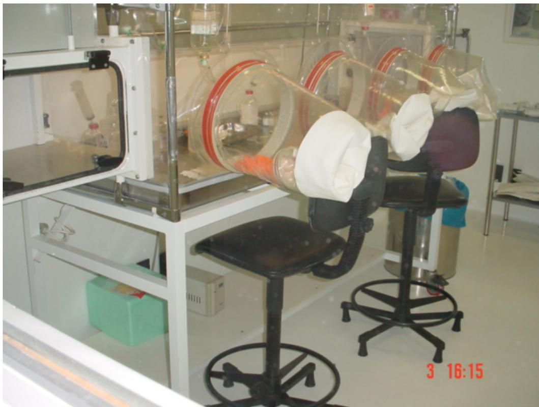
Figura 2 Isolador/capela de manipulação de NPT
