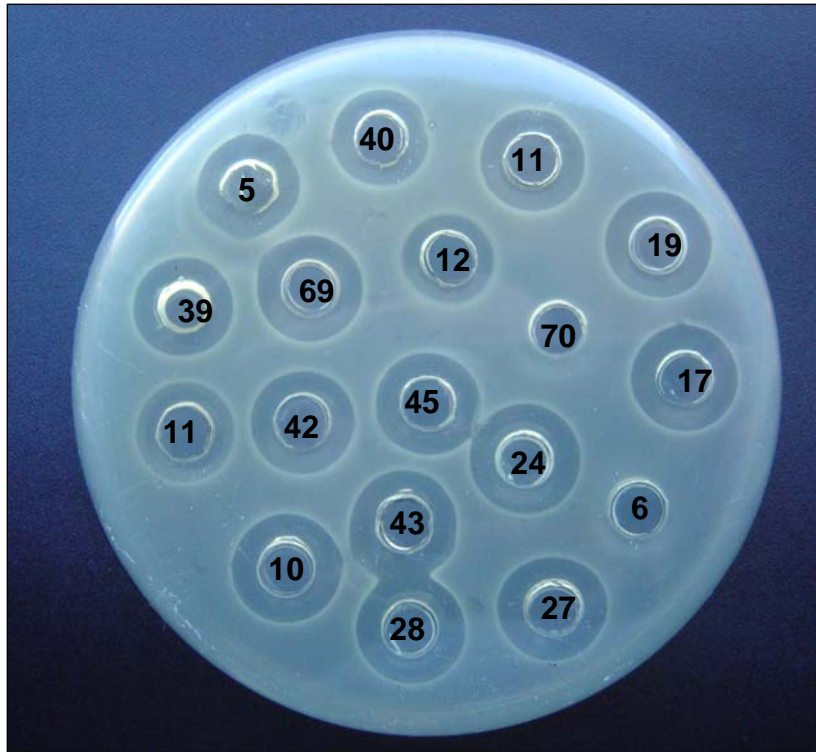
Figura 5 – Teste de difusão em poços com a bactéria Enterococcus faecium 70 como indicadora, incubada a 35°C por 18 horas, mostrando os halos de inibição formados pelos sobrenadantes livre de células.
