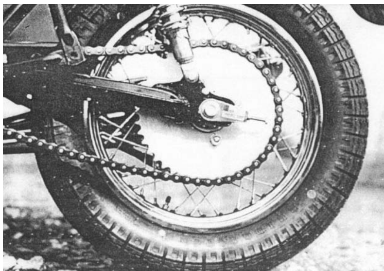
Figura 2.23: Roda dentada de náilon da transmissão por correia da moto de corrida [27]
