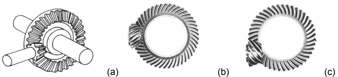
Figura 2.4: Engrenagens cônicas com dentes retos (a) [12] , helicoidais (b) [14] e hipoidais (c) [14]
