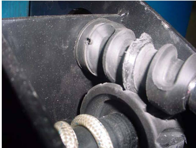
Figura 5.16: Par de engrenagens em PA 6 com 30% de fibra de vidro, após 623 ciclos
