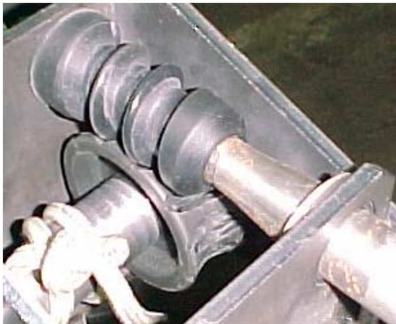
Figura 5.18: Par de engrenagens do porta-estepe de caminhão com pinhão em Technylstar com 60% de FV e coroa em náilon 6 com 30% de FV, após 1200 ciclos
