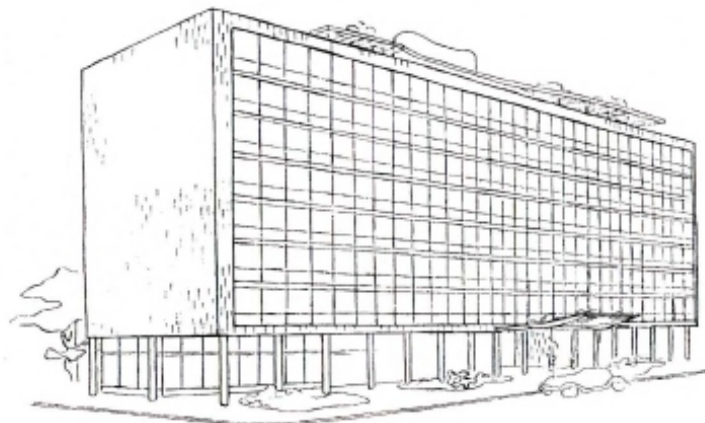
FIGURA 125 - perspectiva da elevação norte com o "mosaico" de elementos vazados e perspectiva da elevação sul a concepção de bloco em pilotis;
