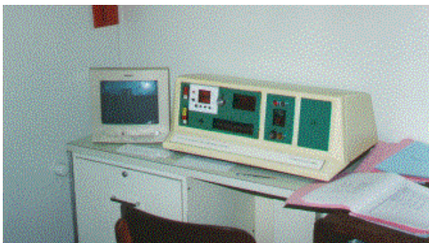
Figura 127: monitor que envia e recebe informações para o aparelho da teleterapia. Fonte: http://radio_teleterapia.vilabol.uol.com.br/radioterapia.htm .
