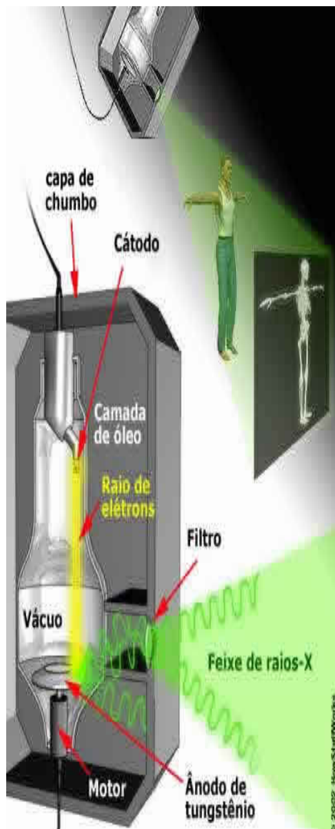
Figura 103: modelo do funcionamento aparelho Raios-X. Fonte: http://novastecnologiassaude.blogspot.com .
