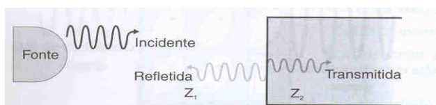
Figura 66: onda ultrassônica interagindo com a matéria. Fonte: Durán, 2003.
