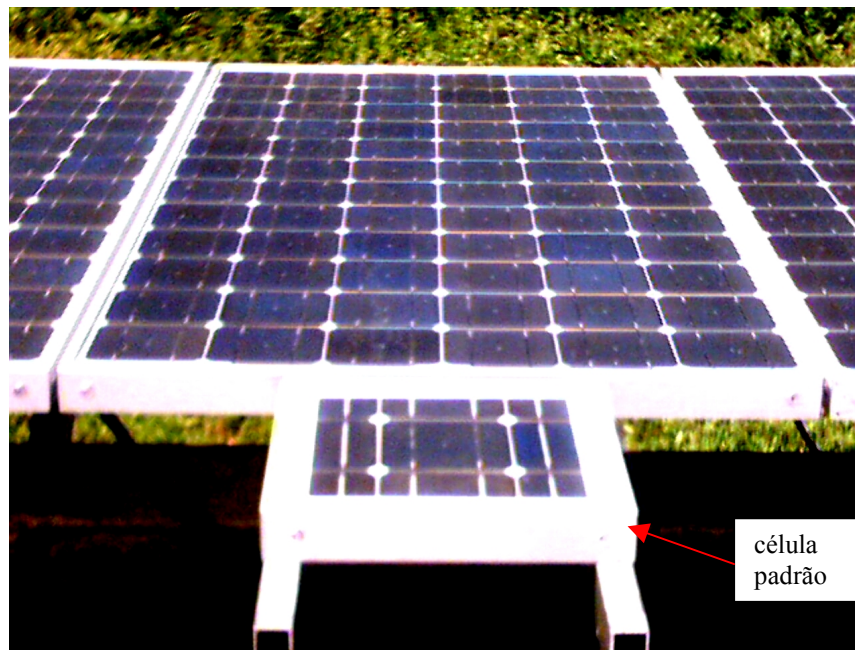
Figura 4.12 Célula padrão para medir a irradiância no plano do gerador.
