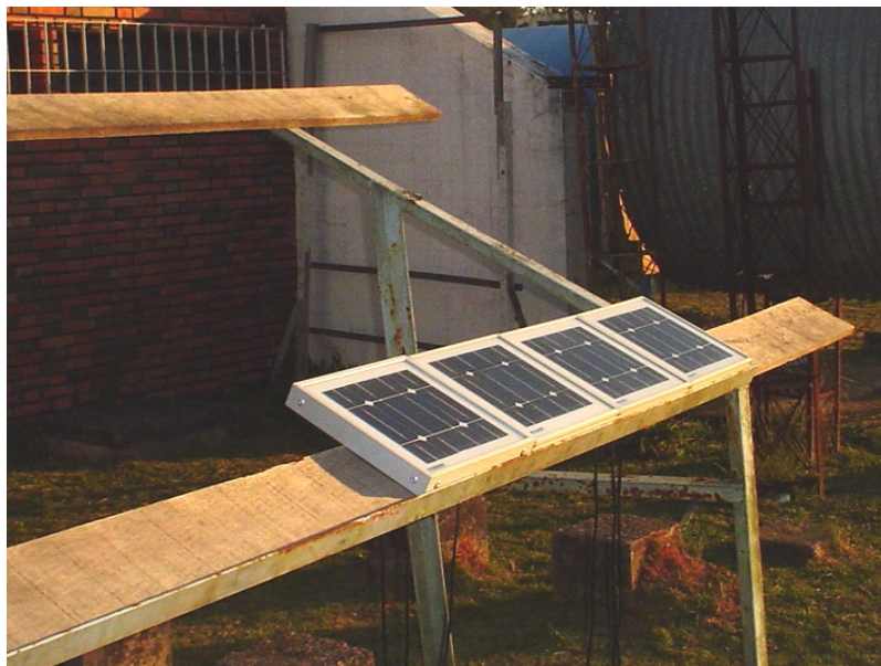
Figura 4.10 Calibração das células padrão.
