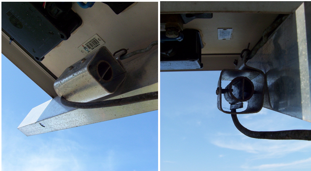
Figura 4.9 Medidor da temperatura do ar ambiente.
