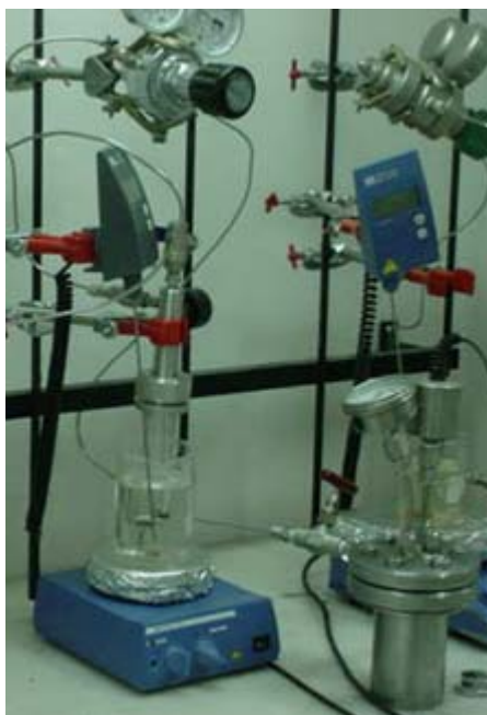
Figura 32. Foto do sistema Fischer-Porter modificado imerso em um banho de óleo silicone com o controlador digital e um reservatório de H 2 .
