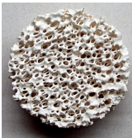
Figura 4.2 - Filtro comercial com densidade linear de 10 poros por polegada, ppi.
