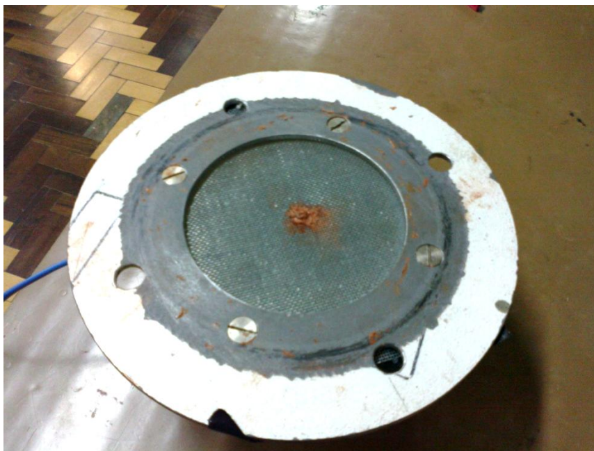
Figura A.6 – Difusor cônico preenchido por esferas de vidro, com termopar instalado no centro da tela de contenção para as esferas.
