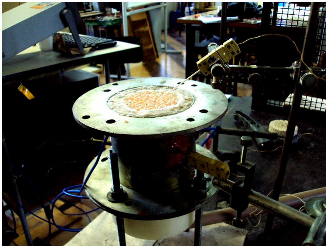
Figura A.7 – Bancada e teste em operação, com meio cerâmico incandescente.
