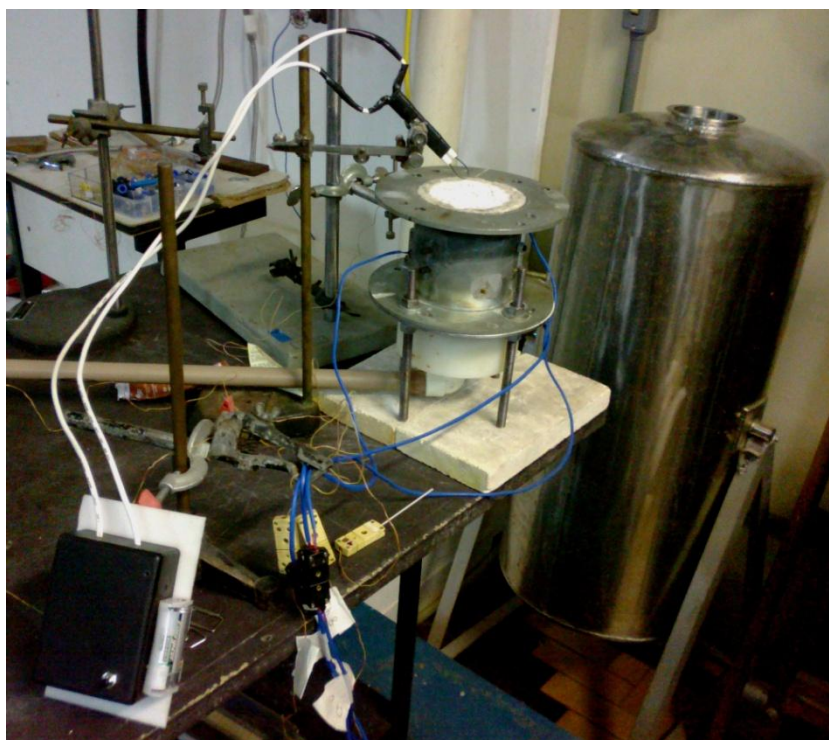
Figura A.7 – Bancada e teste em operação, com meio cerâmico incandescente.
