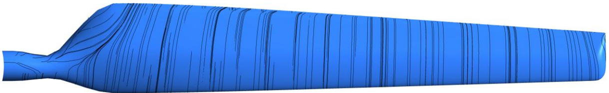
Figura 6.12 Linhas de cisalhamento na pá com vento a 7 m/s
