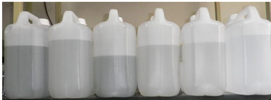
Figura 49 – Soluções do compartimento do cátodo das eletrodiálises ED1, ED2MN e ED3 Real e Sintética, respectivamente. (Os volumes variam em função do tempo de ensaio e número de coletas e análises realizadas para as soluções.)
