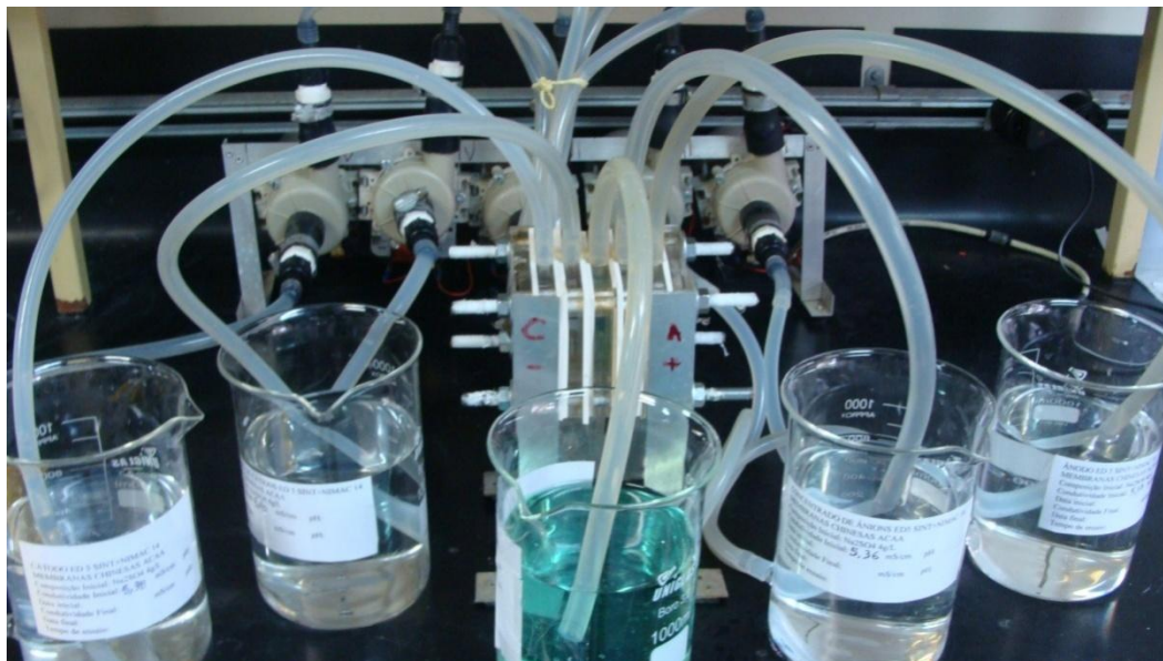
Figura 7 – Sistema de bancada com capacidade de 1L utilizada para ensaios de ED e diálise.
