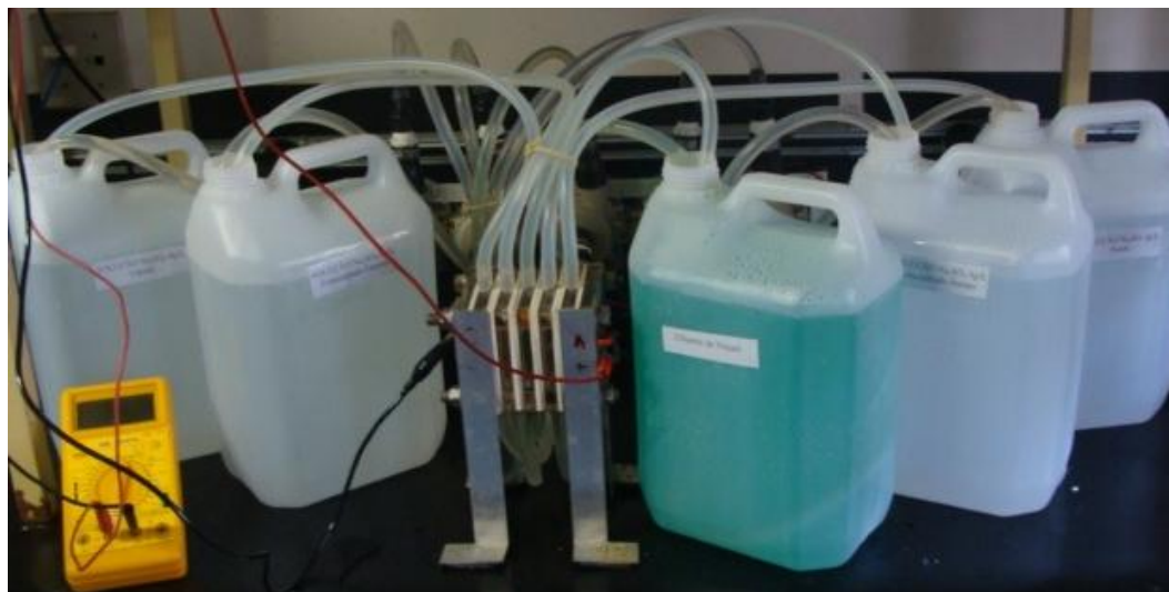
Figura 6 – Sistema de bancada para com capacidade de 5L utilizada nos ensaios de ED.
