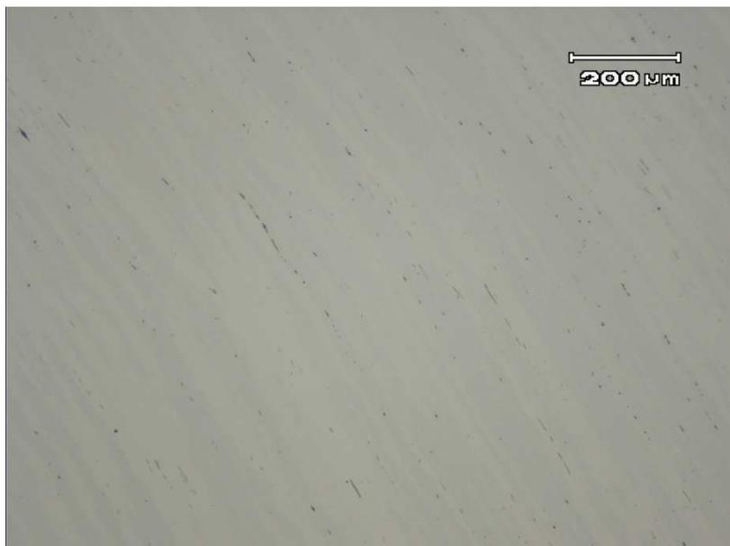
**Figura 17: Micrografias do pino, onde é possível observar inclusões de sulfeto de manganês. Sem ataque.**
