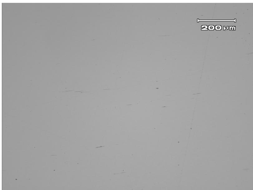
**Figura 16: Micrografias do Substrato, onde é possível observar inclusões de sulfeto de manganês. Sem ataque.**
