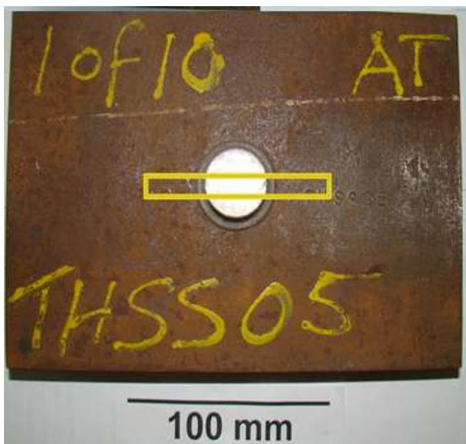
**Figura 10:** Figura mostrando a Identificação da amostra e o local de onde foi retirado o corpo de prova para análise.
