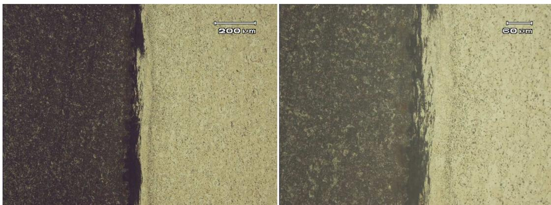
**Figura 22: Micrografia da Zona de Ligação, mostrando uma boa ligação metalúrgica. Ataque Nital 2%**
