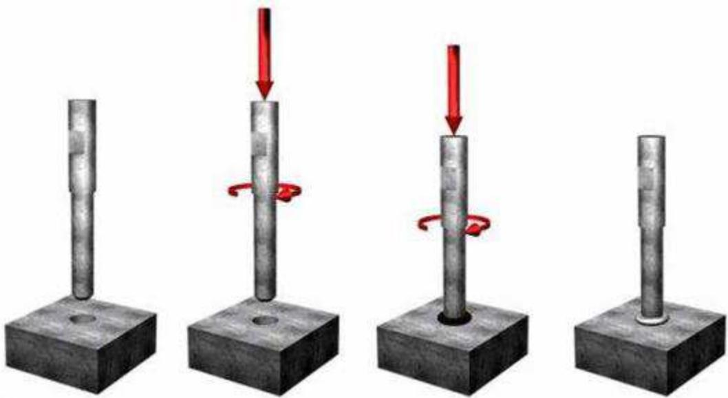
**Figura 4: Seqüências básicas de um processo de soldagem com pinos consumíveis (12)**
