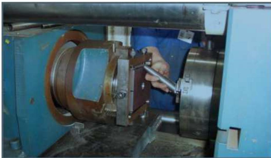
**Figura 9: Maquina de soldagem por fricção, onde foram produzidos os reparos.**
