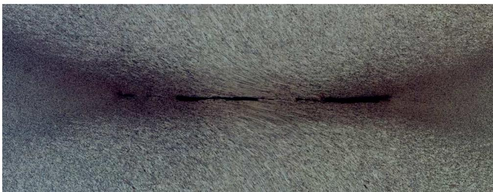
**Figura 26: Micrografia mostrando a microestrutura na região da trinca. Ataque Ácido Oxálico.**
