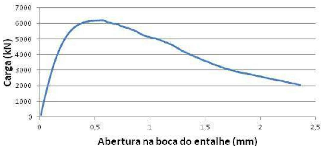
Figura 30: Curva obtida a partir do ensaio de CTOD
