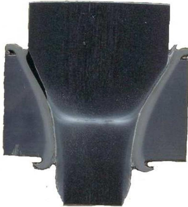
**Figura 14: Macrografia da amostra. Mostrando a presença de uma descontinuidade na região central do pino.**
