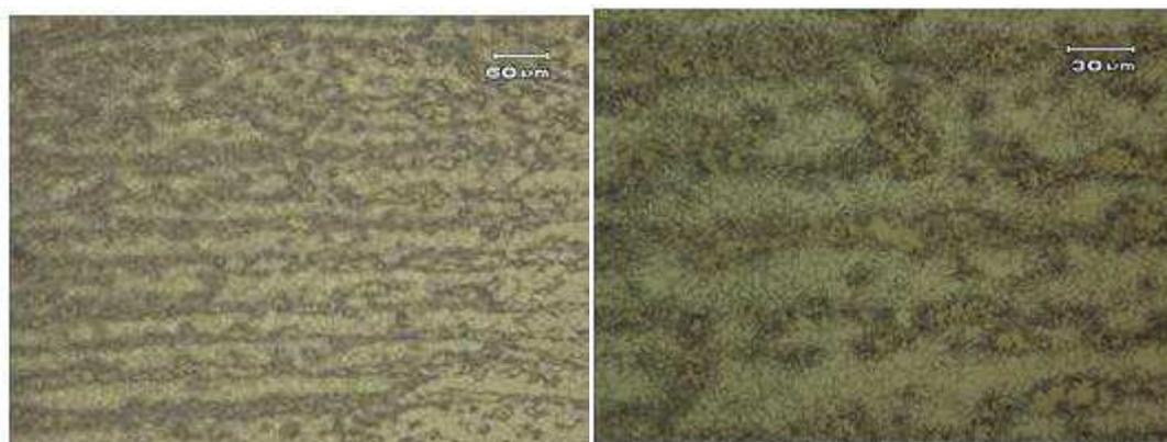
**Figura 20: Micrografias da ZTMA-MB. Ataque Nital 2%**
