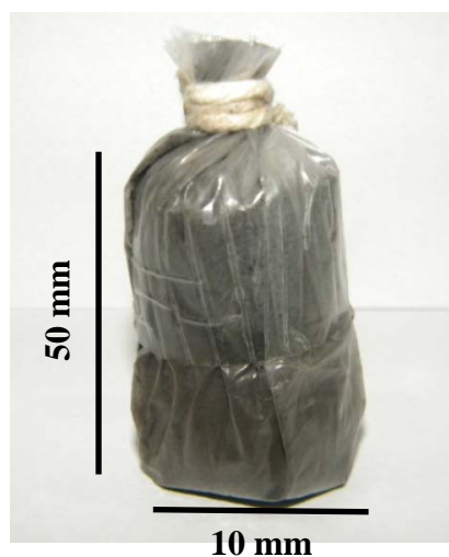
Figura 18. Mistura de carepa e coque de petróleo acondicionada em “bags”.
