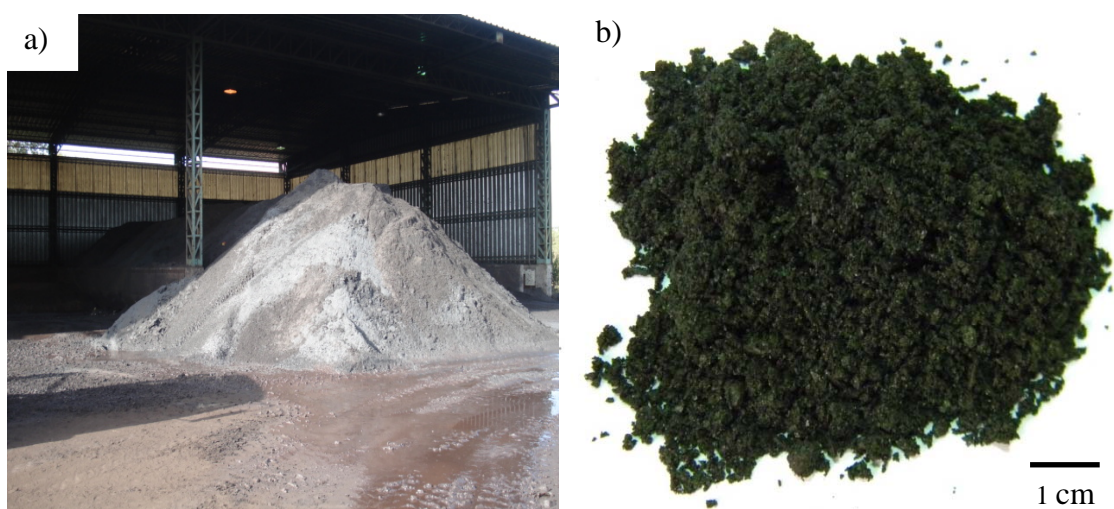
Figura 13. Carepa (a) amostra de laboratório (b) pilha em planta siderúrgica.
