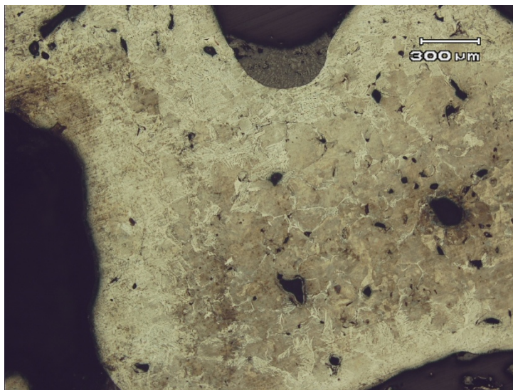
Figura 30. Microestrutura do ferro formado para amostra de 8 minutos.
