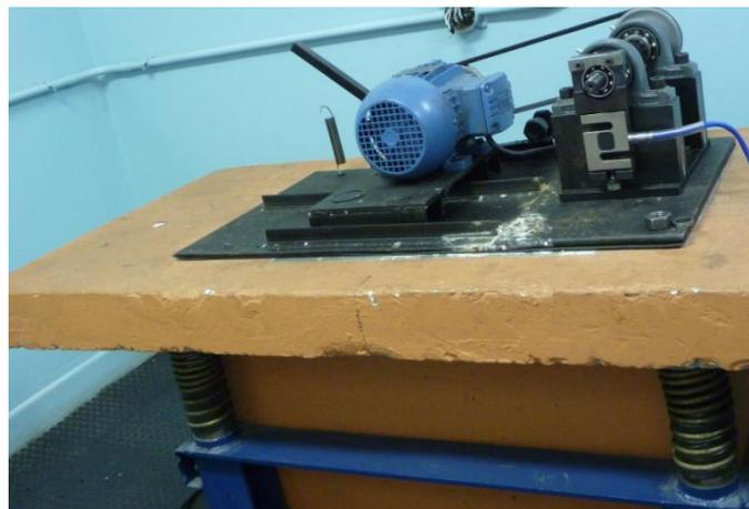
Figura 6.11 - Mesa vibratória com a bancada de ensaios.
