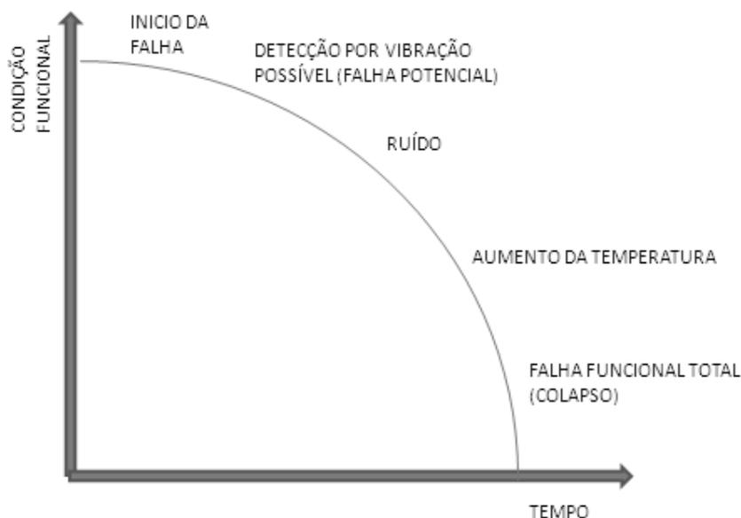
Figura 3.6 - Etapas de deterioração de um rolamento [Adaptado de Vescovi, 2000].
