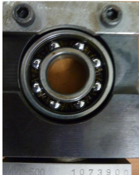
Figura 6.3 – Rolamento na posição de montagem.
