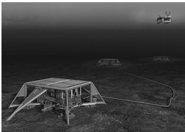
Figura 2 esquema mostrando flowlines assentados no fundo do leito oceânico (< www.statoil.com >).
