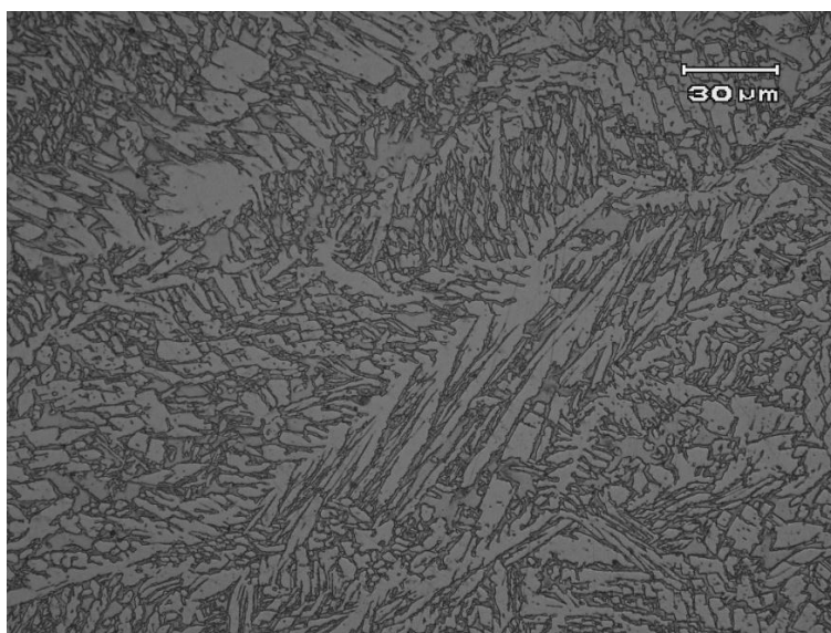
Figura 15 metal de solda. Ataque eletrolítico KOH 56% (foto do autor).
