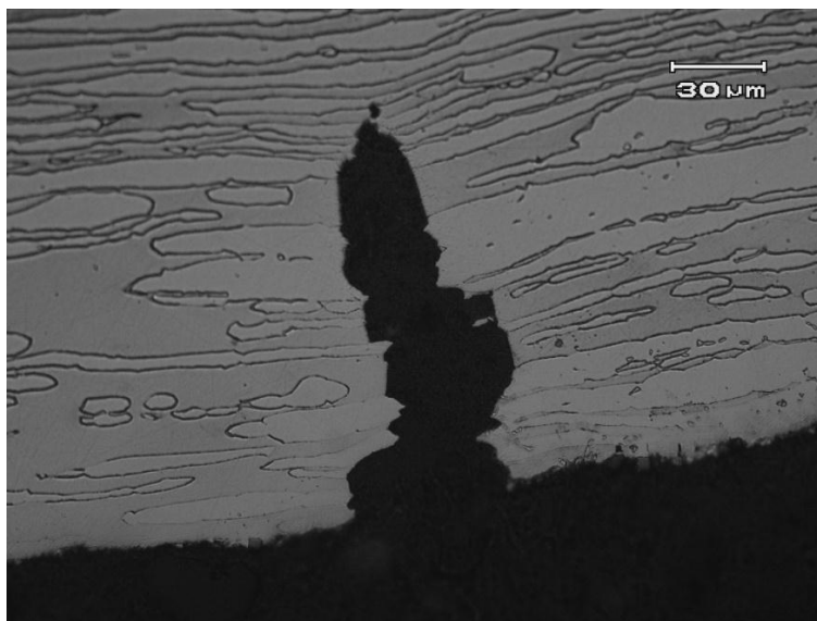
Figura 35 presença de trinca secundária de maior profundidade visualizada próximo a fratura em corpos de prova ensaiados em SSRT em -800\text{mV}_{\text{ECS}} . Ataque eletrolítico KOH 56% (foto do autor).
