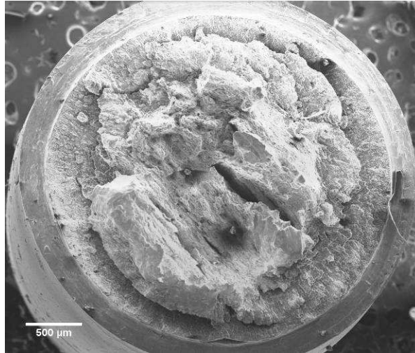
Figura 4.46: Superfície de fratura (25X) do CP ET BTD 007 (com entalhe “intermediário”) ensaiado no meio etanol PRCI SFGE. Observam-se trincas secundárias na fratura.
