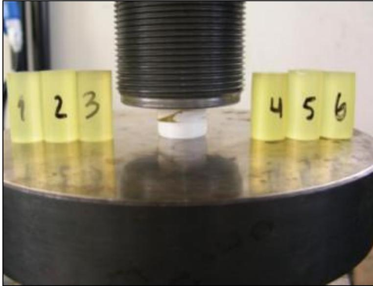
Figura 74 - Ensaio de compressão ASTM D695 e espécimes ensaiados.
