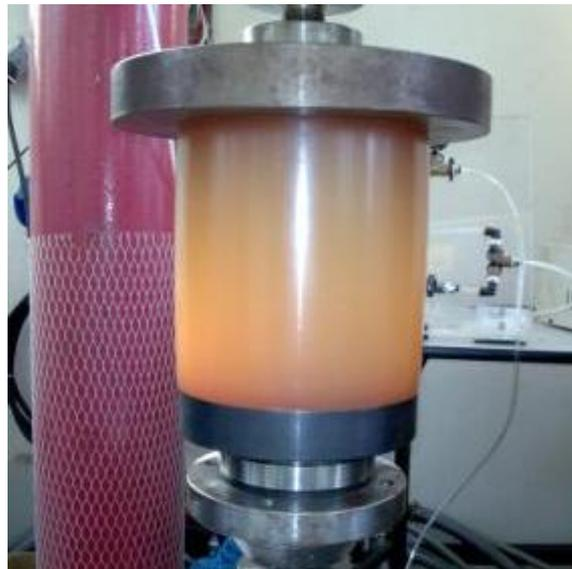
Figura 61 - Ensaio de compressão na mola em escala real.
