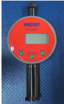
Figura 49 - Durômetro Shore A manual.
