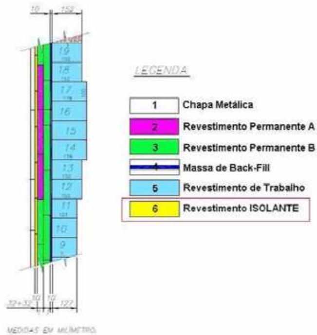
Figura 35 – Descrição dos tipos de revestimento refratários da parede da panela destacando o revestimento isolante. Fonte: GERDAU S.A.
