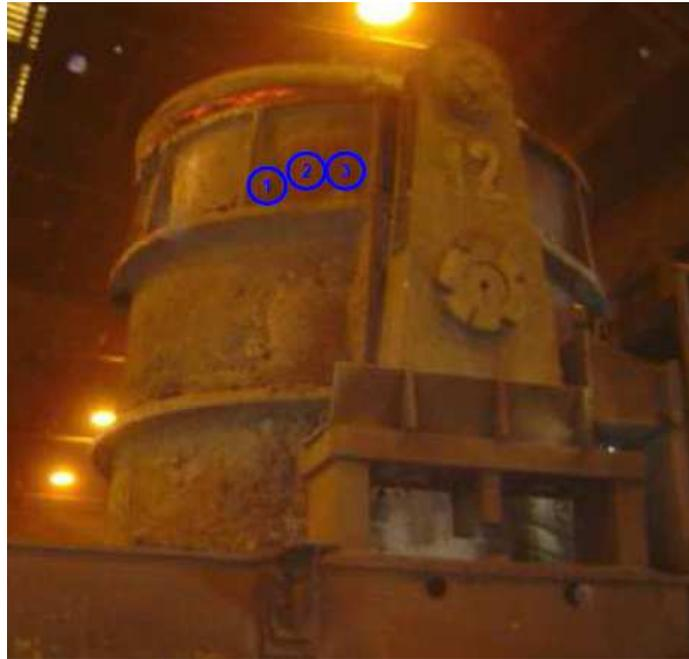
Figura 39 – Localização dos três pontos de medição de temperatura da região da linha de escória da parede externa das painelas. FONTE: GERDAU S.A
