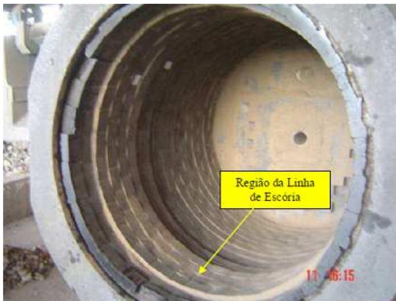
Figura 33 – Disposição do revestimento de trabalho na parede no fundo da panela.
