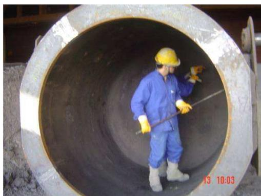
Figura 31 - Foto do interior da panela sem os revestimentos refratários. Fonte: GERDAU S.A.
