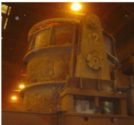
Figura 30 - Foto da panela com tampa na plataforma de lingotamento. Fonte: GERDAU S.A.
