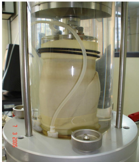
Figura 4.14 – Corpo de prova de areia sã inicialmente denso após ruptura, sob tensão confinante de 200kPa.
