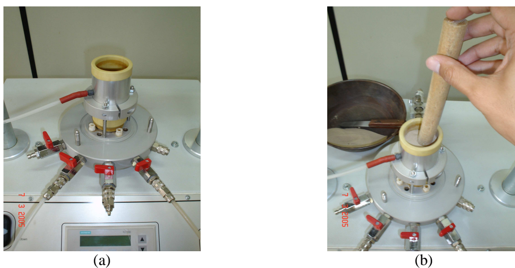
Figura 3.6 – Moldagem de corpo de prova denso: (a) molde bipartido revestido por membrana e conectado por mangueira à bomba de vácuo; (b) compactação da amostra por meio de bastão de madeira.
