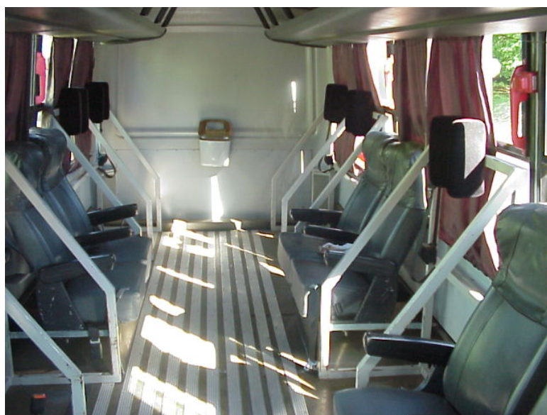
Figura 33. vista do interior do ônibus adaptado para 7 cadeiras de rodas e seus acompanhantes.
