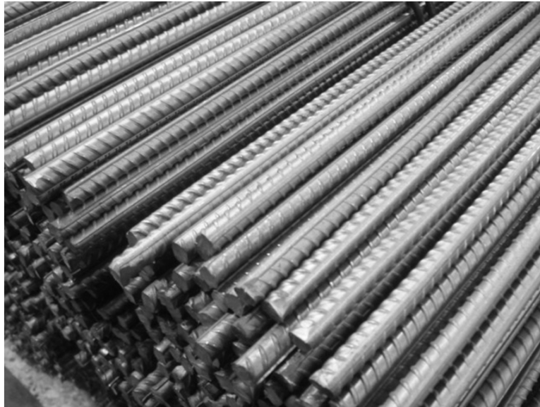
Figura 2.9 Vergalhão de aço de superfície nervurada que atende a categoria CA-50 da norma ABNT NBR 7480 (O AUTOR).
