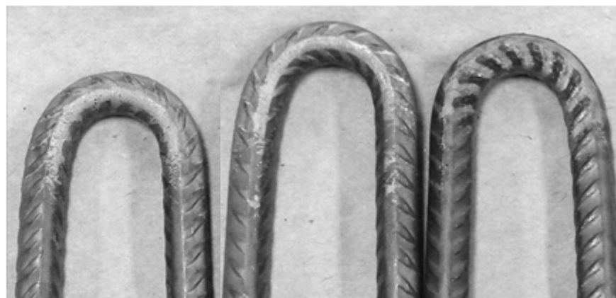
Figura 4.8 Amostras do vergalhão produzido com aço microligado ao vanádio após o ensaio de dobramento.
