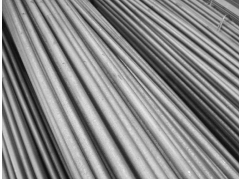
Figura 2.8 Vergalhão de aço de superfície lisa que atende a categoria CA-25 da norma ABNT NBR 7480 (O AUTOR).
