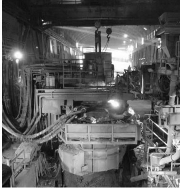
Figura 2.2 Forno elétrico a arco utilizado para a fusão da carga metálica na produção de aço (O AUTOR).
