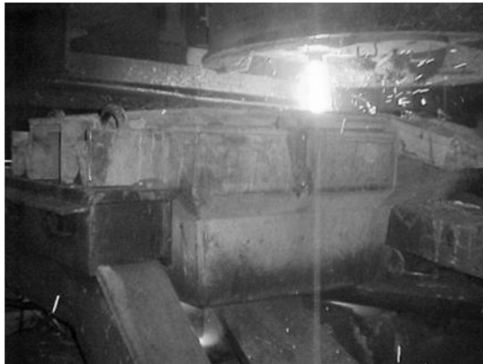
Figura 2.4 Distribuidor repassando aço para a máquina de lingotamento contínuo realizar a solidificação do aço (O AUTOR).
