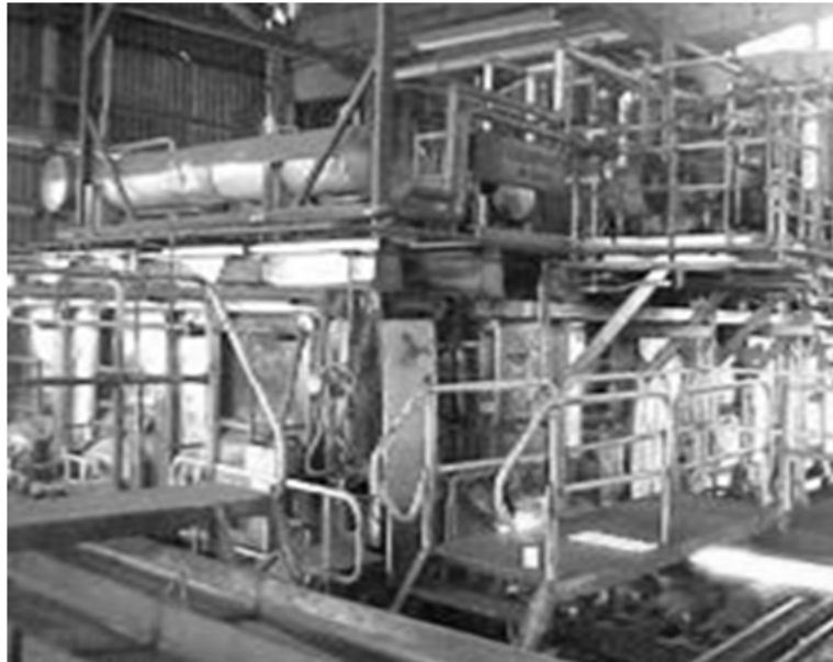
Figura 2.5 Forno de reaquecimento de laminação para tarugos que utiliza como combustível gás natural (O AUTOR).
