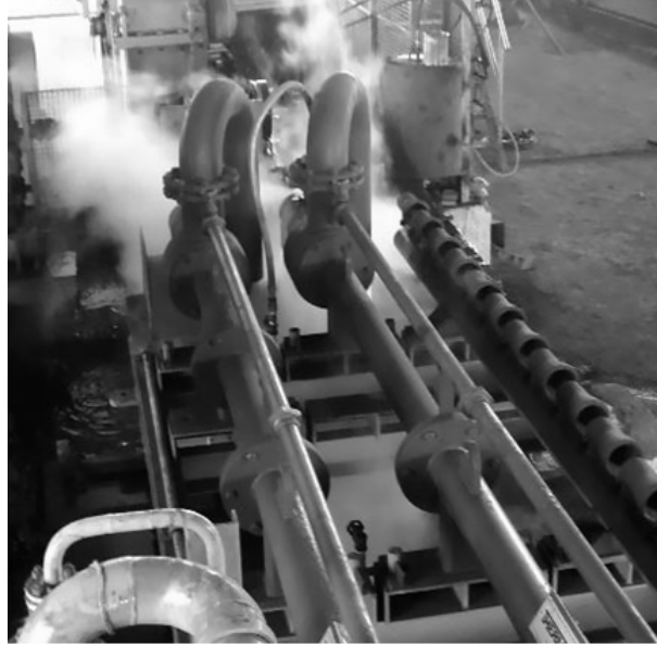
Figura 2.16 Equipamento para realizar têmpera de vergalhões com água em funcionamento em uma laminação (O AUTOR).
