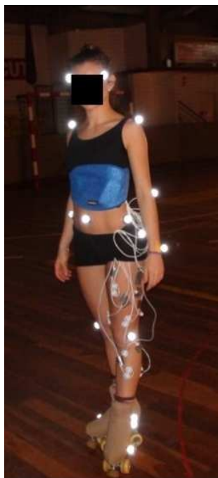
Figura 5. Imagem dos marcadores reflexivos e da cinta utilizada para fixar o equipamento Wireless nos sujeitos.
