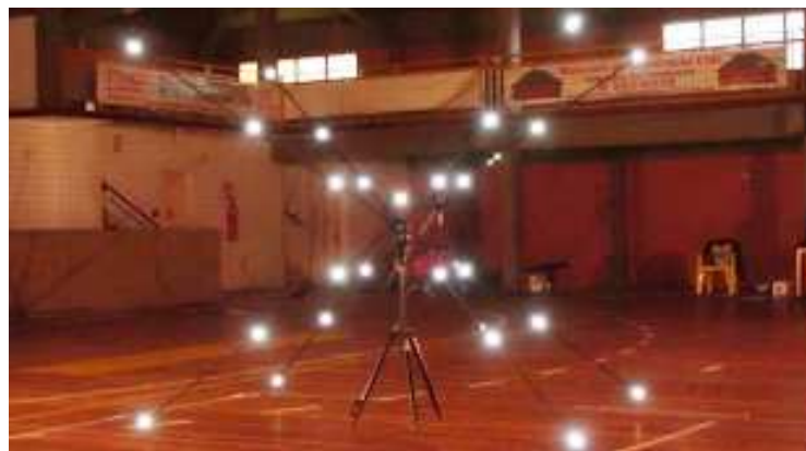
Figura 8. Imagem do calibrador tridimensional utilizado para a coleta cinemática com patins.
