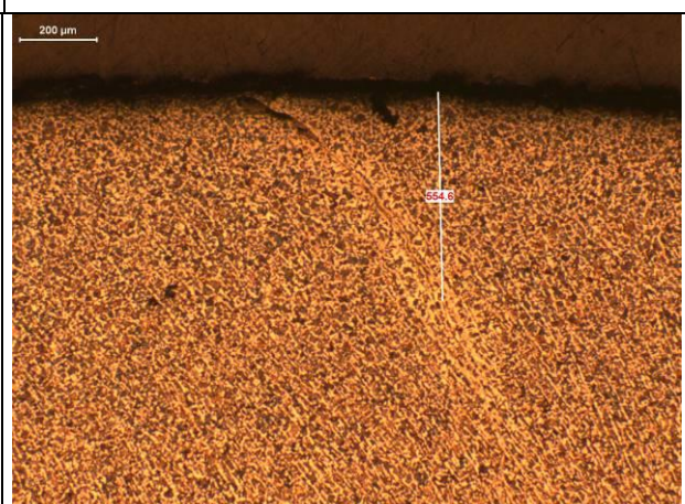
4.4 (l): trinca laminação com 0,55mm, amostra 17.
